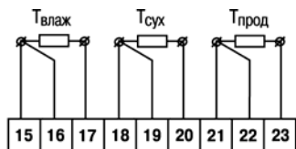
Рис. В.1. Соединение датчиков по трехпроводной схеме
