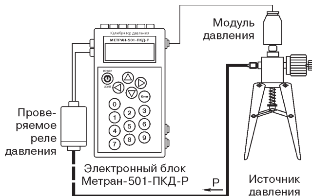
Рис. 3. Проверка реле давления.
